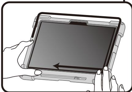
耐水性を確実に発揮するために、シリコンカバーの突起をしっかりとプラスチックフレームにはめ込んでください。
